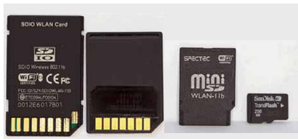
图四 SDIO无线网卡、SD卡、MiniSD无线网卡、TF卡
