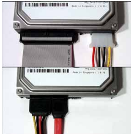
图二 IDE 和 SATA 硬盘接口连接线及电源对比
